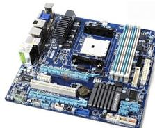
PCB платы изготовлено с удвоенным содержанием меди, применены высококачественные компоненты, подсистема питания (VRM) построена по схеме 4+1 фаза. Характеристики:
